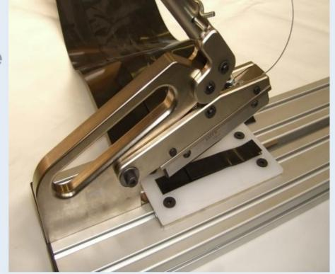
Il dispositivo Coupon Cutter taglia in maniera precisa ed efficace i campioni di saldatura da testare alla prova di peeling con il nostro apparecchio di prova modello Teston, con dimensioni e forma come indicato dalle normative DVS 2225 parte 4.
