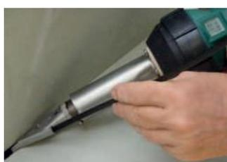
L'apparecchio manuale con e senza display digitale per la saldatura di materiali termoplastici per guaine impermeabilizzanti, pavimenti, teloni, lavorazioni plastiche, ecc.
